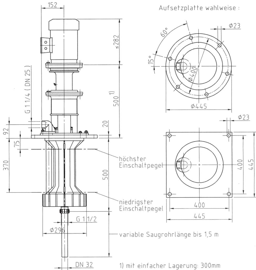
Die Pumpe der Baureihe VKKF bzw. VKKF 25-160 ist eine vertikale Tauchpumpe nach dem bekannten und bewährten Zweirohrprinzip. Zur Erreichung einer höheren Stabilität werden Aufhängerrohr und Druckrohr in einer Baueinheit hergestellt.
